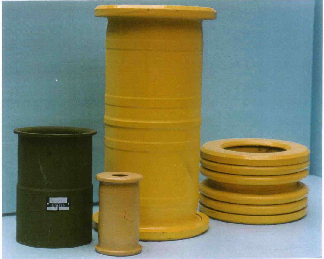
Ein Deformationselement vor und nach dem Auftreten zu hoher Aufprallenergie
