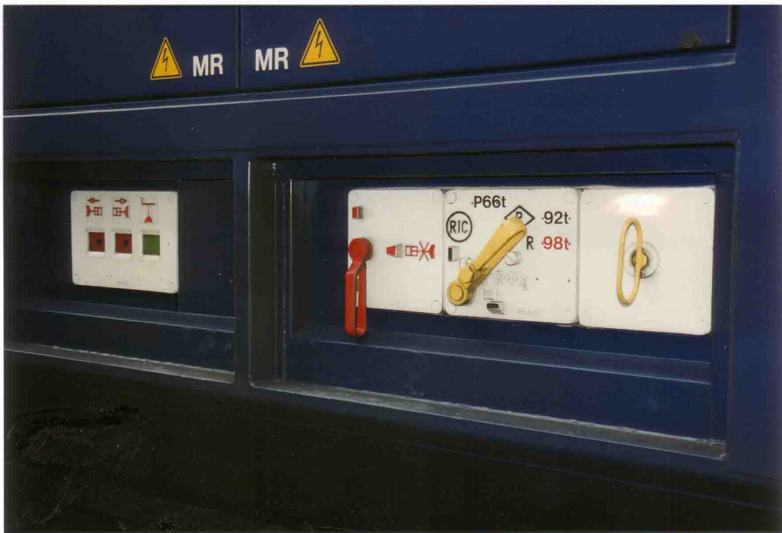
STABEG-ANZEIGEVORRICHTUNGEN AV 2056 und UMSTELLVORRICHTUNGEN EIN-AUS und RIC-R (R+Mg) mit flexiblen Verbindungen
