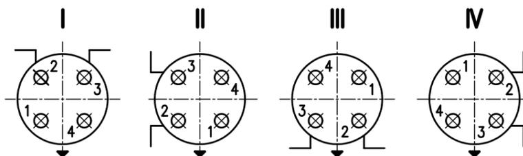
Stellung der Luftanschlüsse zur Befestigung:
